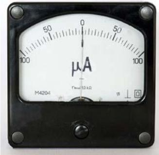
Микроамперметр М4204 предназначен для измерения постоянного тока в электрических цепях. Приборы конструктивно оформлены в черных пластмассовых корпусах. Измерительный механизм - магнитоэлектрической системы, имеет внутрирайонный магнит, крепление подвижной части на растяжках, механический указатель - стрелочный.
