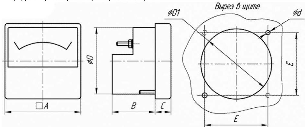
где A - 80мм, B - 36мм, C - 14мм, D - 70мм, D1 - 77,5мм, d - 3,4мм, E - 68,2мм;
