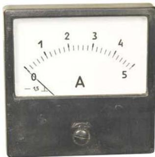
Амперметр М42300 предназначен для измерений тока в электрических цепях постоянного тока. Приборы представляют собой щитовые приборы магнитоэлектрической системы с внутрирамочным магнитом; Измерительный механизм прибора состоит из магнитной системы (обойма, магнитопровод), отсчетного устройства (шкала, указатель) и подвижной части на кернях;
