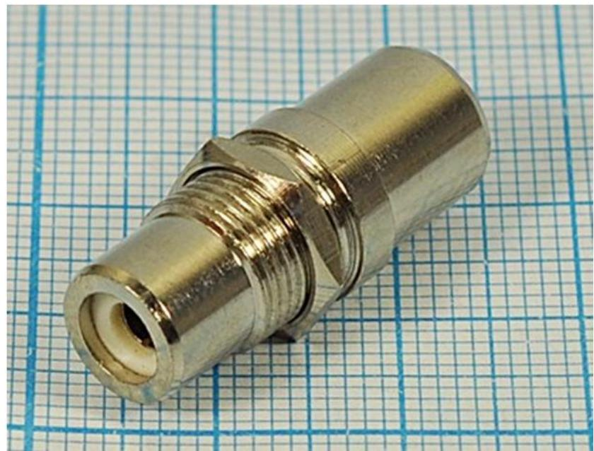
**Переходник имеет никелированный центральный контакт и никелированный корпус. Изолятор изготовлен из фторопласта (полиэтилен, полистирол). Назначение переходника – сопряжение TV разъемов с кабелями и устройствами имеющими разъемы стандарта RCA.**
