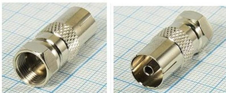
**Переходник предназначен для стыковки кабелей и приборов, имеющих соответствующие ответные части разъемов стандарта TV и F-типа. Переходник имеет никелированный центральный проводник и никелированный (хромированный) корпус. Изолятор, как правило, изготовлен из фторопласта (полиэтилена, полистирола).**
