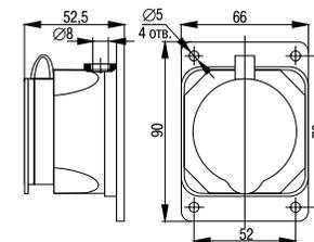
Рисунок 10 - Розетка (колодка) двухместная с защитными крышками РКП16-002
