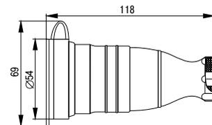
Рисунок 9 - Розетка с защитной крышкой настенная РКН16-1-01
