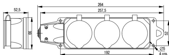
Рисунок 12 - Розетка (колодка) четырёхместная с защитными крышками РКП16-004
