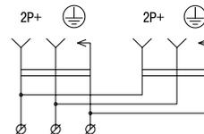
Рисунок 4 - Электрическая схема соединений РКП16-003
